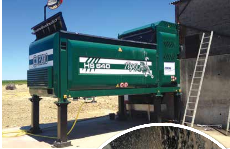
En sortie de la biodéconditionneuse on obtient « la soupe » organique et les emballages vides.
